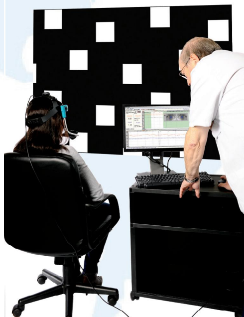
La VNG Ulmer en situation Test oculomoteur avec le masque à champ de vision illimité : le VISIO
